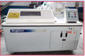
**SINGLETON** PSF22 MULTI FOG CORROSION TEST CHAMBER
