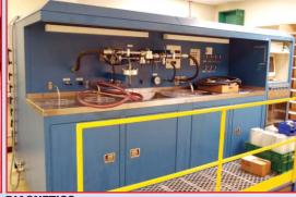
**DIAGNETICS** OIL FILTER MULTI PASS TEST STAND MODEL 4572
